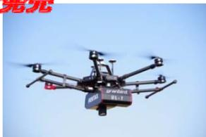
UAV・レーザ測量システムUL-1
