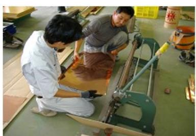
機械による折り曲げ加工
