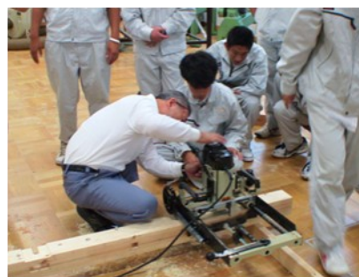
大入れルーターを使用した梁の仕口加工
