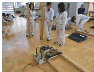
アリ溝加工を専用の機械を使用し行う
