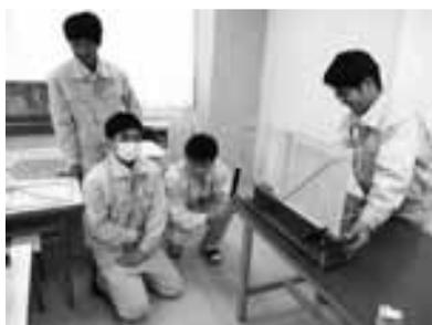
片筋交い壁の模型による引張試験
