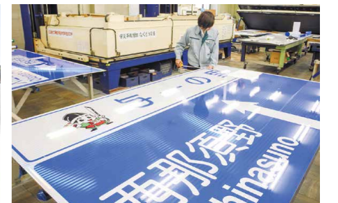
岩澤建設の寺内氏「作図した図面と製作中の標識板の実寸を確認」
