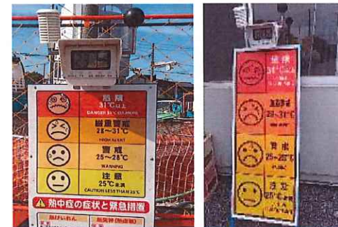
暑さ指数(WBGT)に応じて、マスクを外しての作業を許可 (例：暑さ指数(WBGT)が21℃以上の場合は外してもよい)
