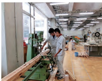
角ノミ盤でホゾ穴を掘る
