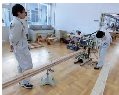
加工機でアリ部分の加工
