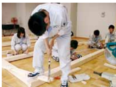
土台の組み上げと根太のほぞ加工
