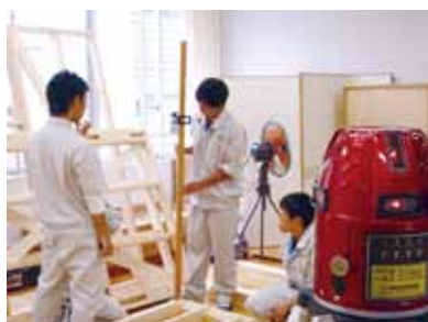
レーザーレベルでの高さ調整
