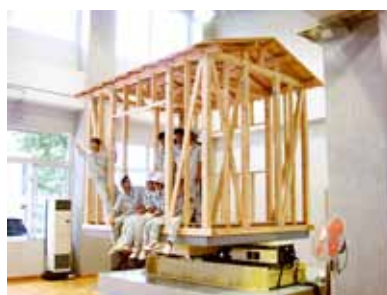
起動装置上の木造軸組建物 (完成)
