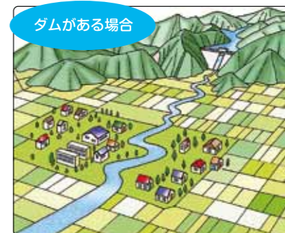
ダムは、大雨のとき水を貯め、一度に大量の水を流さないよう川に流れ込む水の量を調節し、下流域の洪水被害を防ぎます。これを洪水調節といいます。
