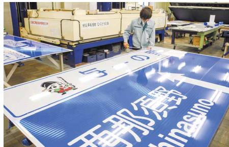
岩澤建設の寺内氏「作図した図面と製作中の標識板の実寸を確認」
