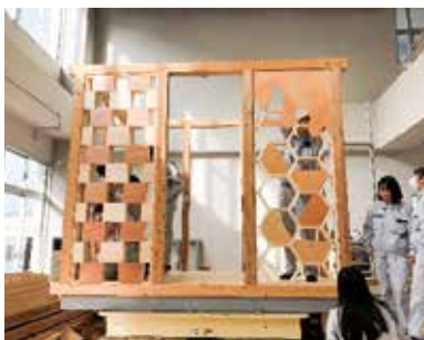
耐震実験モデルに耐震壁を取り付け、実験と検証を行う
