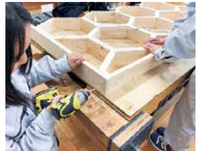
外枠に合わせて、材料を切断し取り付ける
