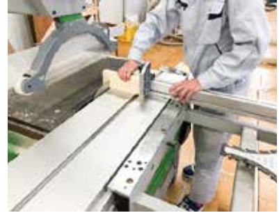
昇降盤を用いて、部品を加工する
