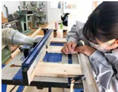
部材を特殊なビットで加工し、六角フレームを作る
