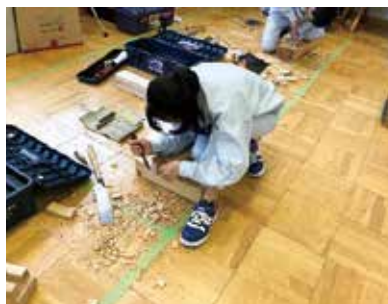
難易度の高い鎌継ぎ加工をノミで仕上げる
