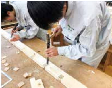
相欠き部分をノミで加工する
