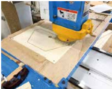
加工プログラムを作成し、NCルーターで部品を加工する
